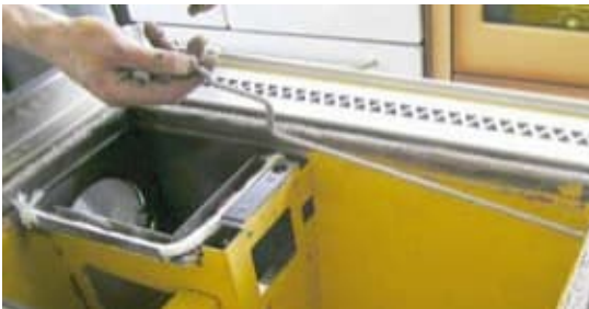
13. Danach das Gestänge der Klappe nach hinten entnehmen
