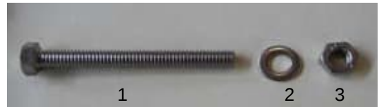
18. Ansicht der Verschlusskomponenten, für das Gestänge der Anheizklappe
