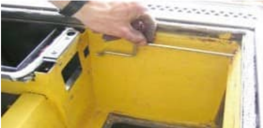
12. Das Gestänge der Anheizklappe nach vorne herausziehen
