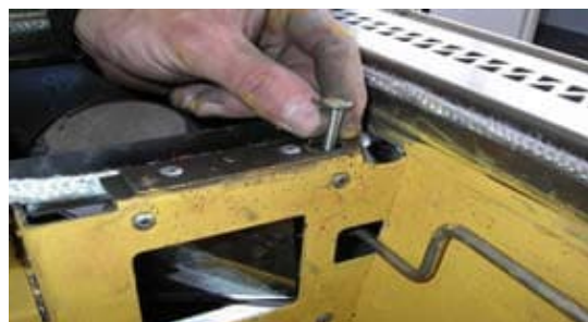
10. Scharnierstift der Anheizklappe heraus-ziehen.
