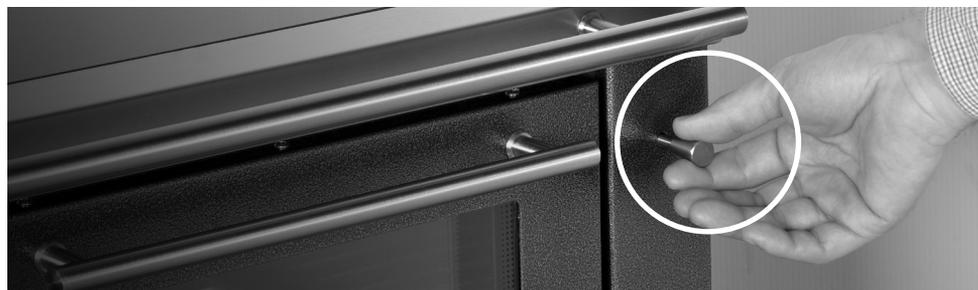
Ziehen Sie am Hebel der Anheizklappe, um den Rauchweg zu verkürzen und dadurch eine raschere Erhitzung des Kamins zu fördern. Nach einer ca. 15-20 minütigen Phase wird somit, bei korrekter Installation, der geeignete Kaminzug erreicht.
