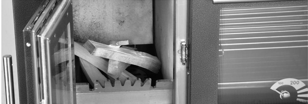
Verwenden Sie bei den ersten zwei Ladungen sehr dünnes Holz mit einem Durchmesser von nicht mehr als ca. 3 cm, immer unter Beachtung der Höchstauflagemenge. Verwenden Sie zum Anzünden kein Papier da dies die Entstehung von Flugasche fördert und somit eine häufigere Reinigung des Herdes und des Schornsteins erforderlich wäre. Somit eine häufigere Reinigung des Herdes und des Schornsteins erforderlich wäre.
