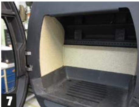
7 Linke Seitenplatte montiert
