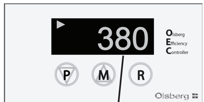
Anzeige Feuerraumtemperatur 380°C → Anwahl der Anzeige Feuerraumtemperatur oder Luftschieberstellung erfolgt über die Tasten P oder M
