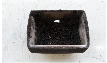
BEISPIEL VERSCHMUTZTE BRENNSCHALE
