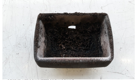
BEISPIEL VERSCHMUTZTE BRENNSCHALE
