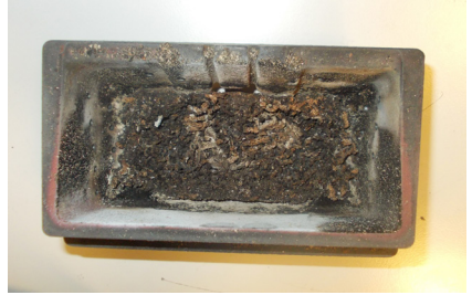
BEISPIEL VERSCHMUTZTE BRENNSCHALE
