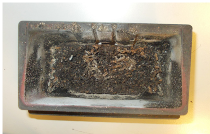
BEISPIEL VERSCHMUTZTE BRENNSCHALE
