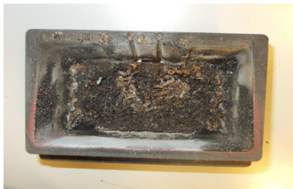
BEISPIEL VERSCHMUTZTE BRENNSCHALE
