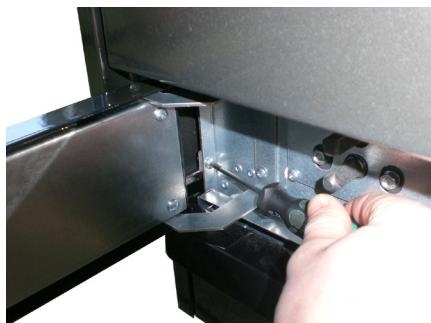
2. Die Aschenlade herausnehmen, die Blendenbefestigungsschrauben lockern und gewünschten Sockelrücksprung einstellen, Schrauben wieder festschrauben.
