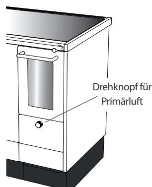
In Stellung „0“ ist der Regler geschlossen, es wird keine Verbrennungsluft zugeführt. In Stellung „1“ erfolgt mini-
