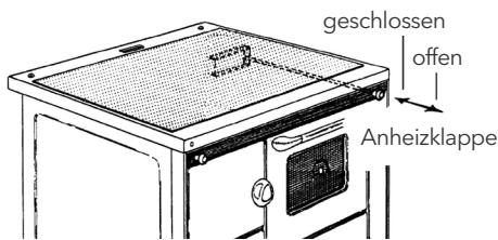
**HINWEIS:** Die Anheizklappe darf nur in der Anheizphase geöffnet bleiben. Eine während des Heizbetriebes offen stehende Anheizklappe führt zur Überhitzung des Herdes und damit zu Schäden an Herdelementen. Außerdem hat eine offen stehende Anheizklappe erhöhten Brennstoffverbrauch zur Folge.
