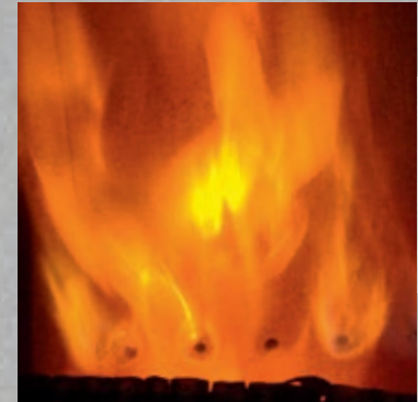
Tertiärluft wird durch Düsen im hinteren Brennraumbereich „eingeblassen“
