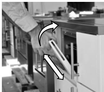
Backofentür langsam schließen und einen leichten Druck nach oben ausüben. Dabei lösen sich die Scharniere aus der Arretierung. Danach Backofentür abnehmen.
