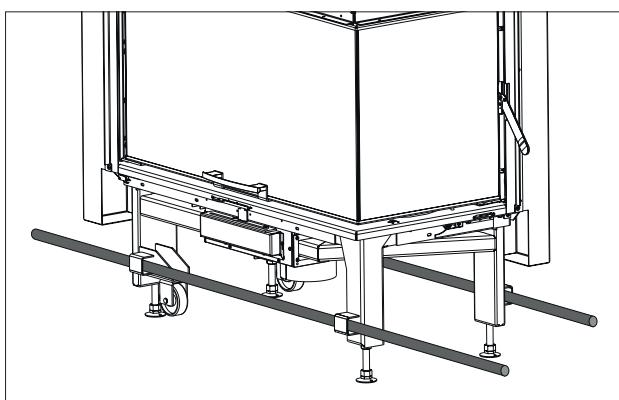
Um das Gerät aus der Palette zu entfernen, lösen Sie die Befestigungsschrauben (A) an den Füßen der Palette, heben Sie das Gerät aus der Palette und achten Sie besonders darauf, die Tür und ihre Scheibe vor mechanischen Stößen, die sie beschädigen könnten, zu schützen.
