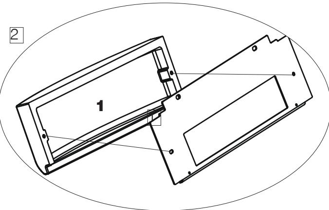
3. Die untere Frontblende aus Metall - **1** (mit montierter unterer Keramik-Frontblende) am Ofen anschrauben. Die Frontblende kann durch Betätigung der Schrauben in den Langlöchern nach rechts/links auf die Tür ausgerichtet werden.
