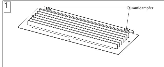
2. Das Gitter unter der Keramik- oder Natursteinplatte anbringen und mit den mitgelieferten Schrauben M4 befestigen.
