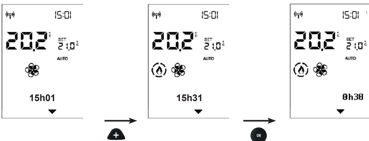
Auf der Leiste wird weiterhin der Countdown angezeigt, der nach unten zählt, bis das Gerät aus- oder eingeschaltet wird.
