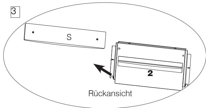
4. Die Halterung mit dem Keramikteil wieder am Ofenkörper anbringen und mit den unter Punkt 1 abgenommenen Schrauben befestigen.
