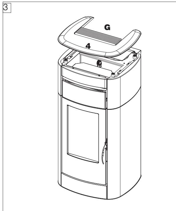
Eventuelle Einstellungen können durch Betätigung der Tragstifte des Oberteils oder wie unter der Montage der Seitenteile erläutert über die Schrauben unter den Seitenteilen ausgeführt werden (Oberteil und Seitenteil sind abgenommen).
