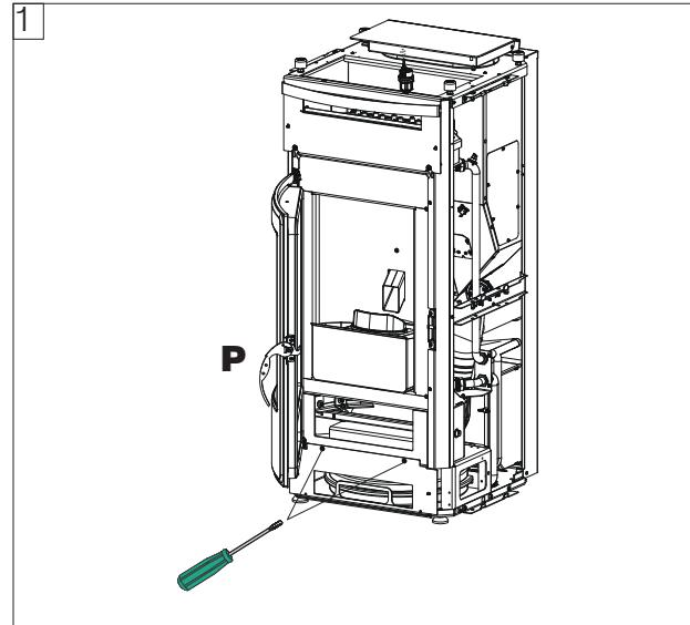
2. Das Keramikteil mit den Schrauben M4 mit Unterlegscheiben an der unteren Frontblende aus Metall anschrauben.
