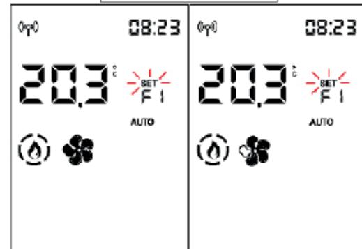
Die Einstellung wird mit der Taste bestätigt, um dann ggf. zum nächsten Ventilator zu wechseln (nur für die kanalisierten Versionen PLUS), andernfalls verlässt man die Einstellung Ventilator und die Anzeige SET hört auf zu blinken.
