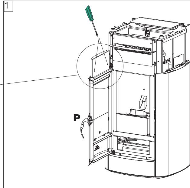
2. Die beiden oberen Schrauben lösen und die Frontblende (1) aus Keramik oder Naturstein auf der Metallhalterung über der Tür einsetzen. Sie rastet seitlich ein und wird oben festgeschraubt.
