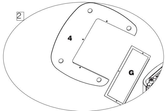
3. Den Deckel des Pelletbehälters öffnen und das mit dem Oberteil aus Keramik verschraubte Gitter am Ofen auflegen.
