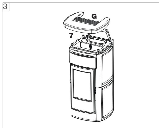
Eventuelle Einstellungen können durch Betätigung der Tragstifte des Oberteils oder wie unter der Montage der Seitenteile erläutert über die Schrauben unter den Seitenteilen ausgeführt werden (Oberteil und Seitenteil sind abgenommen).
