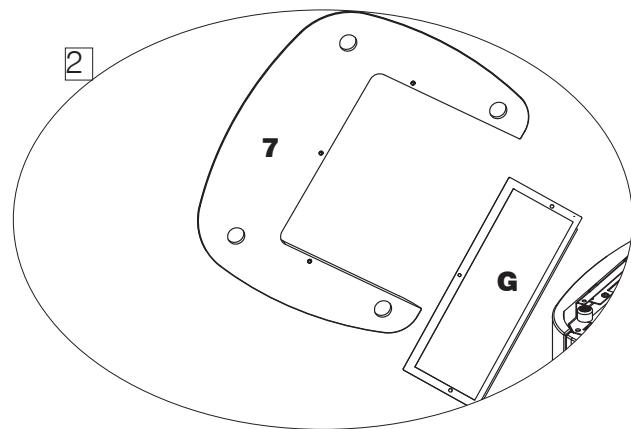
3. Den Deckel des Pelletbehälters öffnen und das mit dem Oberteil aus Keramik verschraubte Gitter am Ofen aufliegen.
