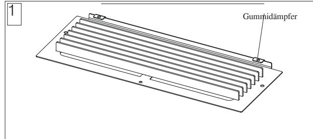
2. Das Gitter unter der Keramik- oder Natursteinplatte anbringen und festschrauben (Schrauben M6 für Naturstein, Schrauben M4 für Keramik).
