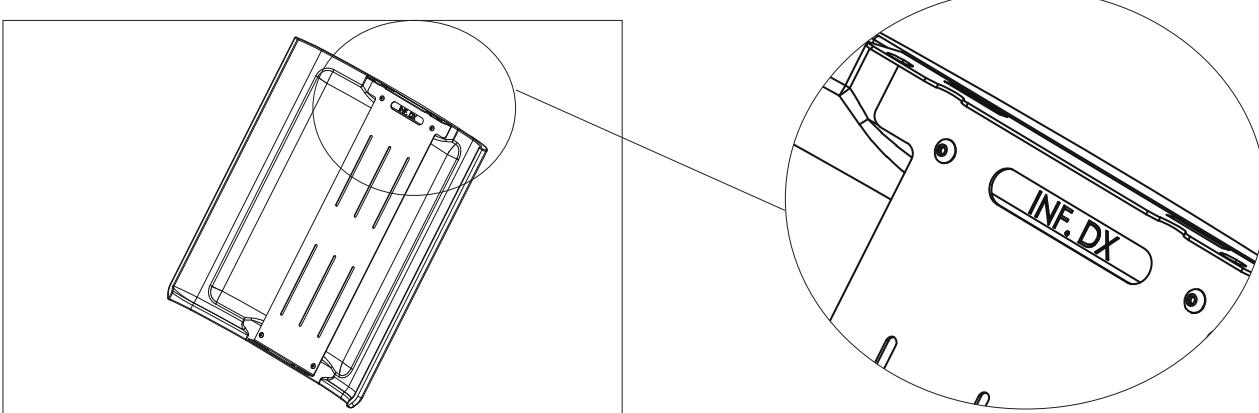
Das Metallgitter des Oberteils befindet sich im Packstück des Ofengrundkörpers mit den drei Befestigungsschrauben M4 und Unterlegscheiben und den beiden am Gitter anzubringenden Gummidämpfern.
