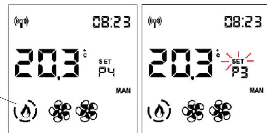
Die Einstellung wird mit der Taste bestätigt oder indem man 5 Sekunden wartet, ohne Tasten zu drücken.
