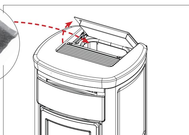
Zum Schließen des Deckels von KIRA2 EVO den Haken wie in der Abbildung unten entsperren.
