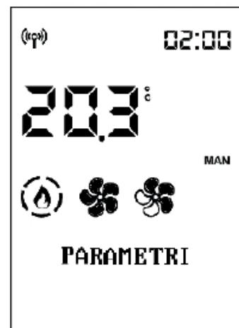
Zum Scrollen durch die Parameter verwendet man die Tasten und und mit den Tasten und verändert man den Wert
