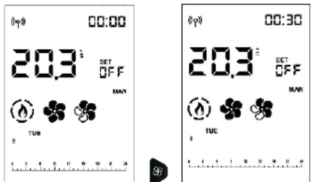
Mit den Tasten und werden die Temperatur-(OFF – T1 und T2) oder die Leistungsstufen (OFF – P1 und P5) verändert.
