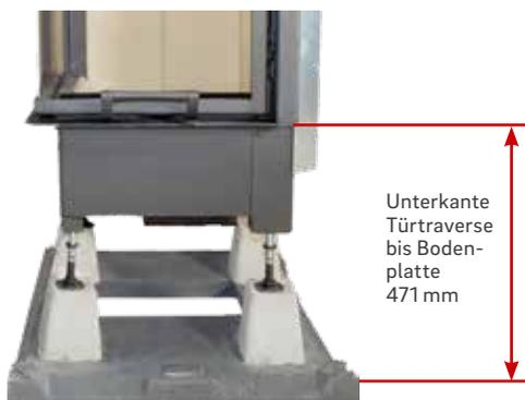
3. Kamineinsatz auf die Betonfüße setzen und mittig auf der Bodenplatte mit Wasserwaage ausrichten. Höheneinstellung Kamineinsatz = 471 mm
