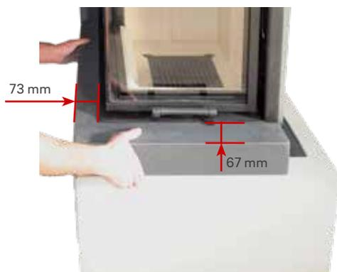
5....und Bankelement zur Ecke flächenbündig **ohne zu Verkleben** auf das Unterteil setzen. Kamineinsatz evtl. nachjustieren.
