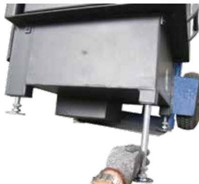
2. Langen Stellfuß auf 145 mm kürzen und unter der Frontecke des Kamineinsatzes anschrauben.
