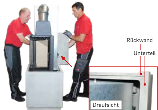
14. Rückwandmodul Höhe 598 mm mit Hinterlüftung und seitlichen Lufteinlässen nach unten ohne zu verkleben auf die Bodenplatte setzen . Hinterlüftung zeigt zur Wandseite!
