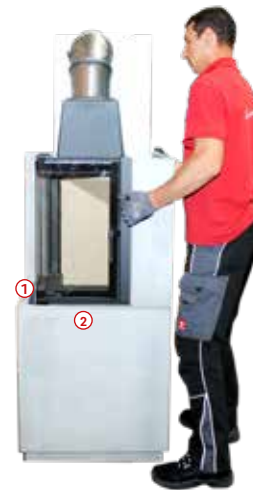
16. Zweites Seitenteil ohne zu verkleben auf das Unterteil setzen und ausrichten (Kamineinsatz evtl. nachjustieren). Abstände zum Kamineinsatz: 1. = 66 mm / 2. = 66 mm
