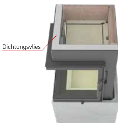
13. Innenauskleidung vorsichtig wieder einsetzen und vorderes Dichtungsvlies auflegen.
