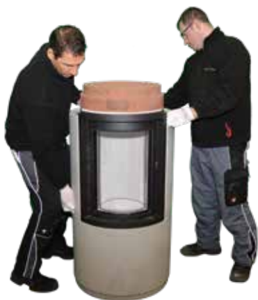
23. Seitenteile rechts und links ohne zu verkleben auf die Unterbauteil setzen und gleichmäßig zur Zarge ausrichten.
