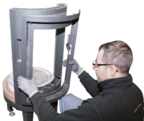
13. Alle 4 Schrauben der Türzarge mit Innensechskant-schlüssel 4 mm lösen und die Zarge vorsichtig zur Seite legen!
