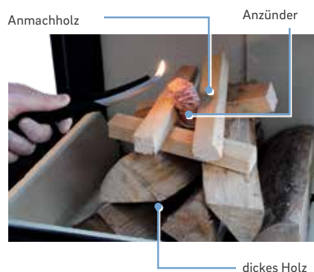
Abb.: 9 Beispiel des Anzündvorgangs, Scheitholzmenge entsprechend der Vorgabe „23 Scheitholztabellen“ auf Seite 48 auflegen.
