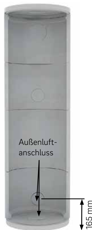
47. Abschluss-Schamottering mit Anschluss zur Decke auflegen.
