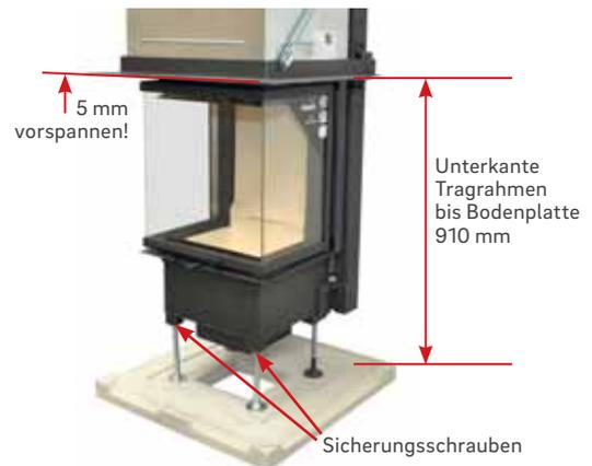
8. Kamineinsatz nach hinten kippen und die beigelegten 20 cm Stellfüße montieren. Abstand von der Unterkante Tragrahmen bis auf die Bodenplatte = 910 mm. Den Tragrahmen vorne ca. 5 mm vorspannen und ausrichten.
