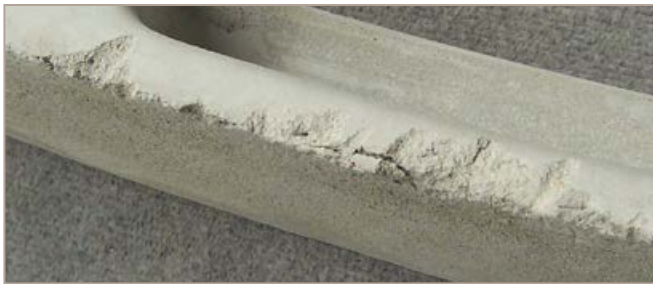
Abb. 71: Beispiel oberflächliche Abplatzungen
