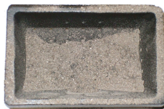
Fig. 32 - Beispiel für eine schmutzige Brennschale
