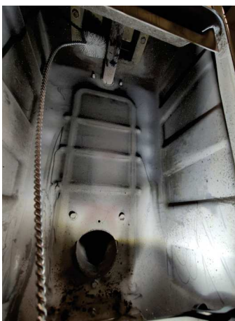
Fig. 81 - Mit einer Rohrreinigungsbürste reinigen
