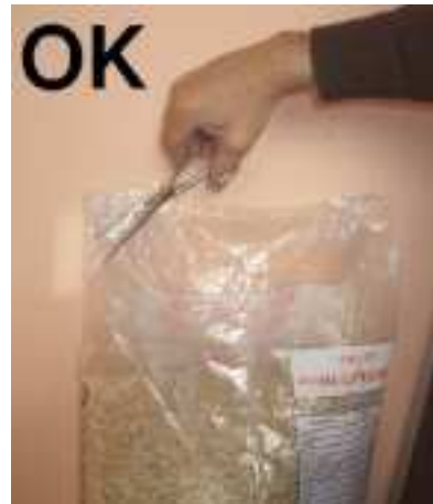
Fig. 25 - Korrekte Öffnung des Pelletsacks
