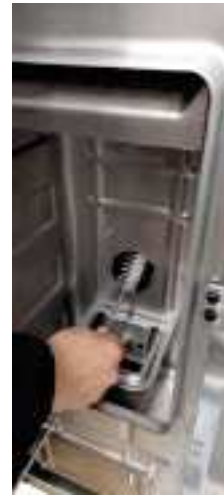
Fig. 36 - Reinigung mit Flaschenbürste
