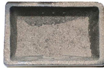
Fig. 32 - Beispiel für eine schmutzige Brennschale
