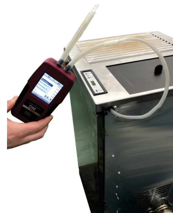
Fig. 24 - Anschluss des Digitaldruckwächters 1
